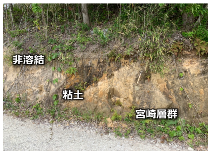
宮崎層の上部に粘土層 (礫あり) 火山灰層は西側 厚さ不明
